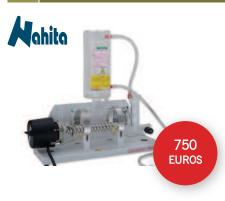
1 | Résistance en cuivre revêtu de Nickel/Chrome d'une puissance de 3KW
